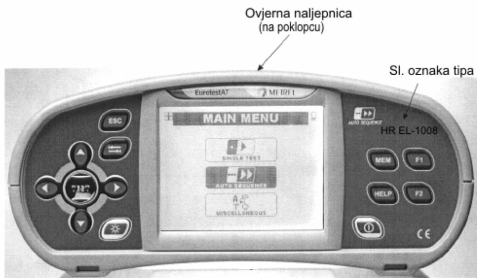
Slika 1. Višenamjenski uređaj za ispitivanje električnih instalacija tip Eurotest
